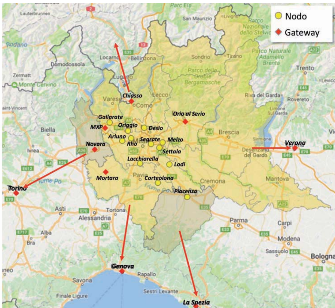
Figura 1.5 Localizzazione dei nodi e dei gateway della RLM per l'analisi di accessibilità
