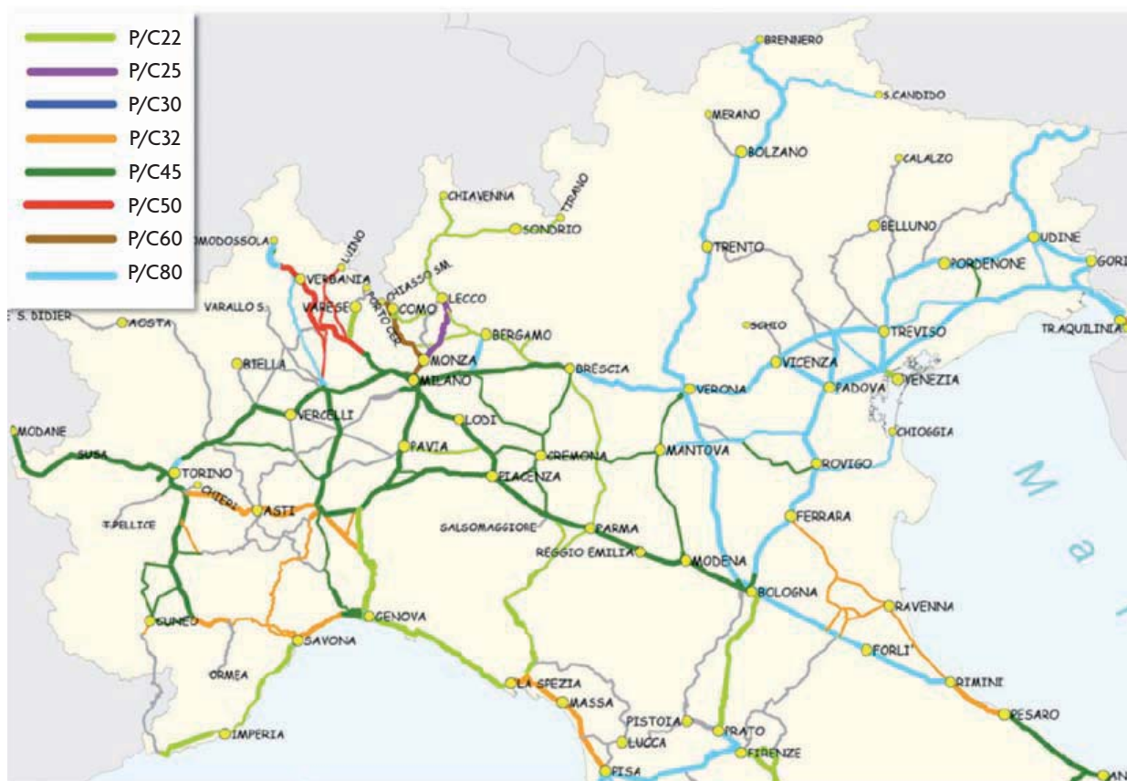
Figura 1.8 Limite di sagoma sulle principali tratte ferroviarie del Nord Italia
